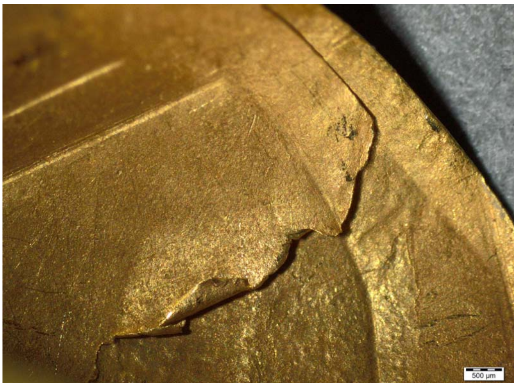
Überlagerung von Goldblechschichten aufgrund eines Gussfehlers, raue Oberfläche der Rückseite und rückseitige Grate an den Löchern
