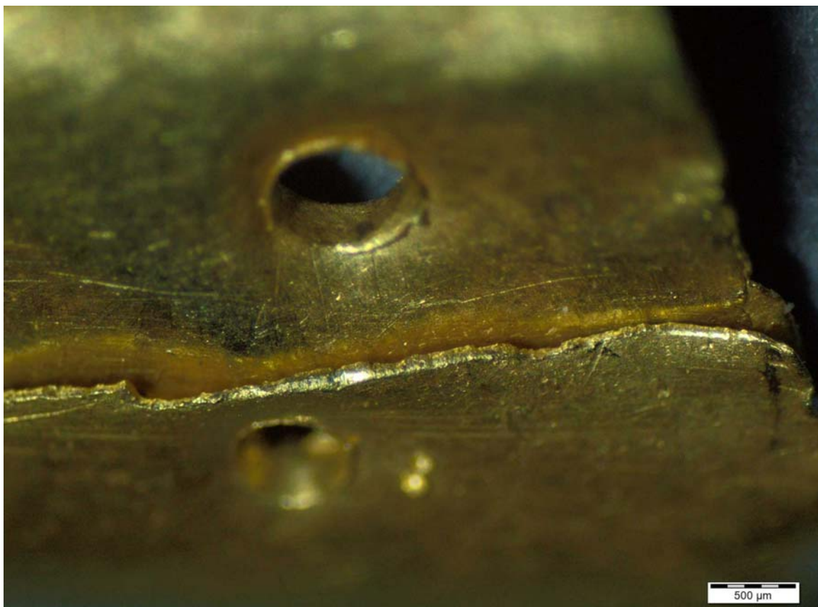
Perforationen von der Vorderseite und Überlappung des Blechs an der Bruchstelle
