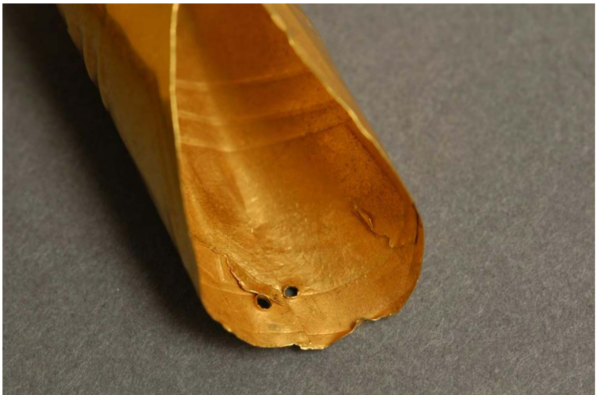
Riss, blättrige Lagen von Gold aufgrund eines Lunkers und Reparatur durch gedornete Perforation
